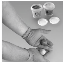
Moule réalisé au moyen du caoutchouc de silicone EasyMold.
