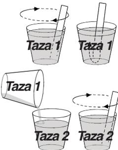
**3. DESMOLDADO:** Deje que su vaciado fragüe y endurezca durante 10 a 15 minutos. Nota: Los vaciados delgados pueden tardar más tiempo para endurecer debido a que hay menos aumento de calor, mientras que los vaciados más gruesos tardarán menos tiempo. Las temperaturas ambientes más cálidas o más frescas y la humedad también pueden afectar el tiempo de endurecimiento. Deje que las piezas vaciadas se enfríen y endurezcan completamente antes de lijar, taladrar, darles forma, etc.
